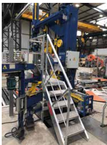
• Escalier d'accès machine
